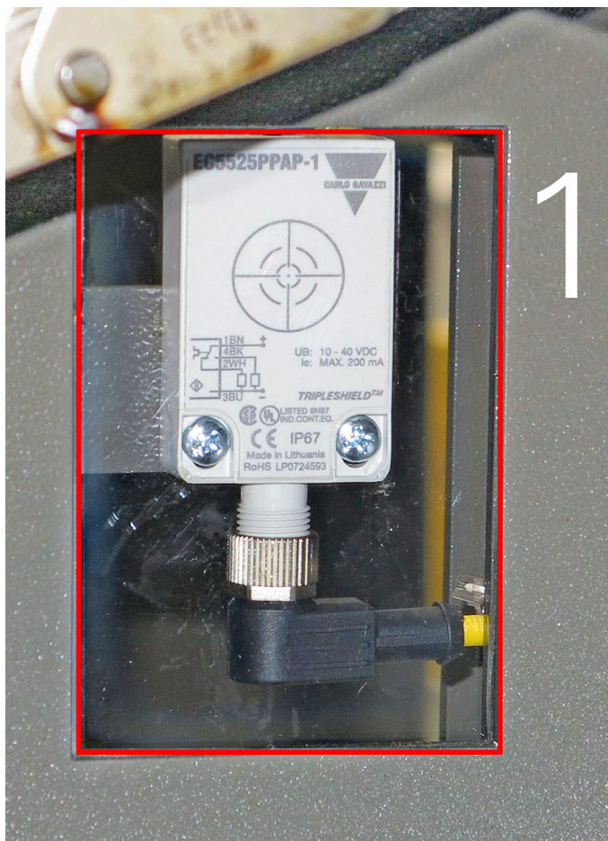
Abbildung 3: Sichtscheibe am Sensor (Ansicht von innen)
