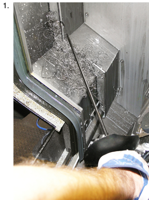
Exemple : Enlèvement des nids de copeaux à l'aide d'outils appropriés (crochet p.ex.)
