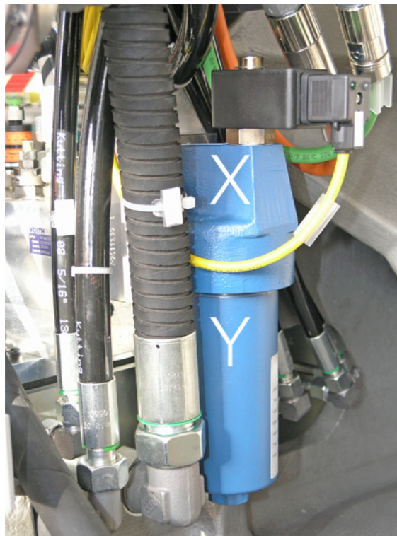
Beispiel: Hydraulikfilter C100/C200
