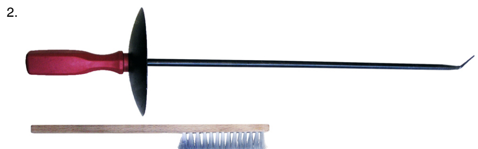
Abb.: Werkzeug zum Entfernen von Spänen
