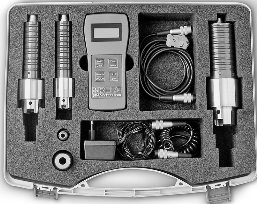
Beispiel: Spannkraftmesssystem Fa. Berg
